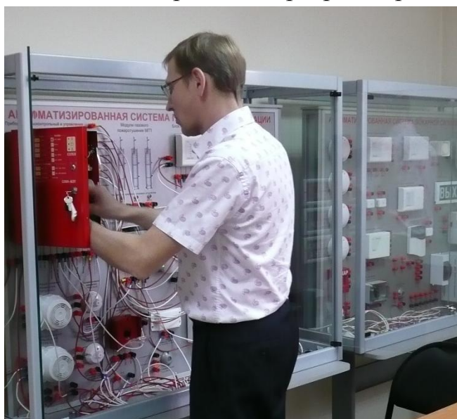
Рисунок 2 – Выполнение работы на стенде-тренажёре АПС
